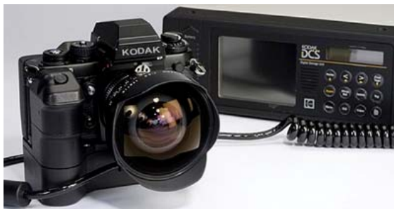
Prima cameră digitală din lume: Kodak DCS 100, tip SLR, de 1,3 MP, cu monitor propriu de control (SUA, 1991)
